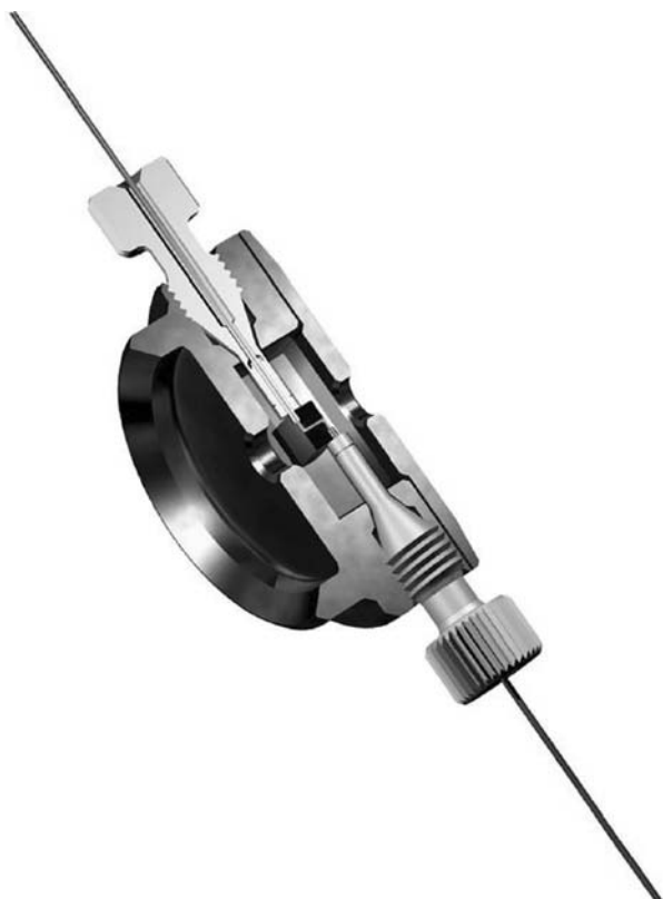
Figura 21.22. Corte transversal de una celda de flujo Z para electroforesis capilar. (Cortesía de Agilent Technology.)
