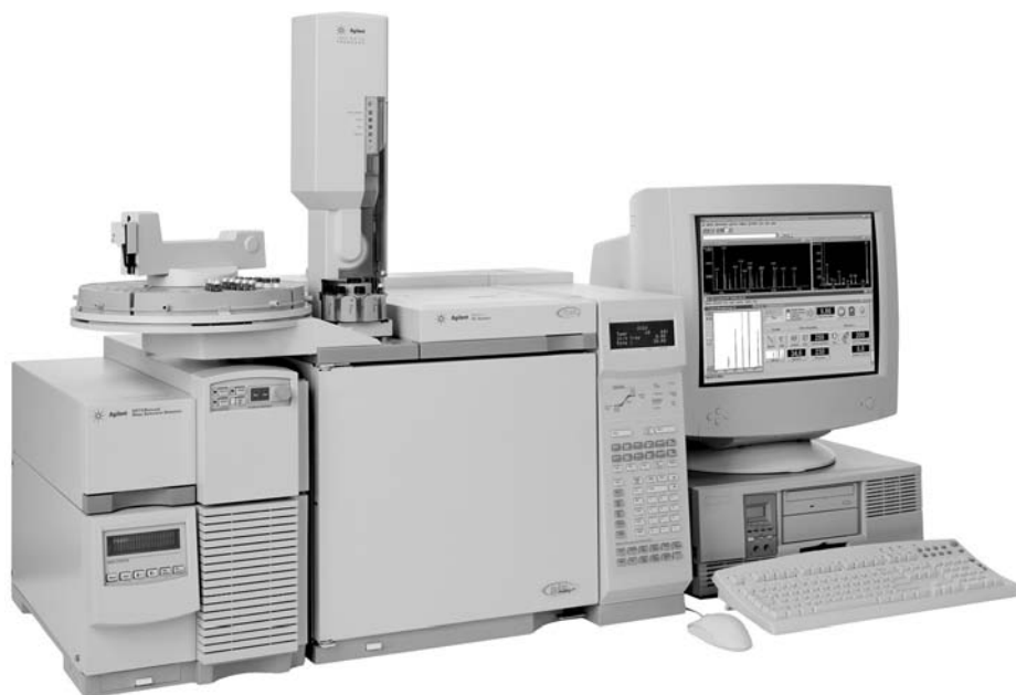
Figura 20.8. Sistema de escritorio para cromatografía de gases-espectrometría de masas. (Cortesía de Agilent Technologies.)
