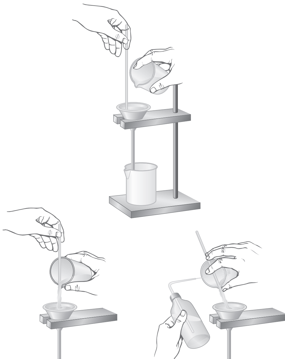
Figura 2.24. Técnica correcta para transferir un precipitado.
